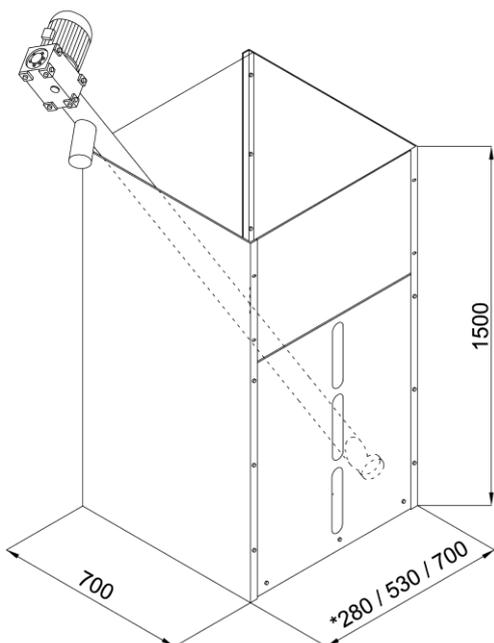
Il contenitore del pellet può essere fornito in tre diversi tagli di capacità:
