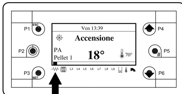
Questa è la fase di preriscaldamento della resistenza di accensione, sul display si illumina il led  $\sim\sim\sim$ . Ha durata di 2 minuti e il ventilatore passa alla minima velocità.
