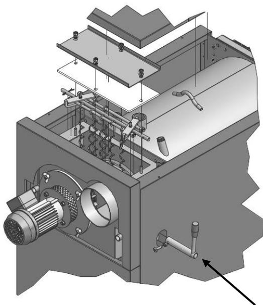
Nella parte laterale del mantello si trova un foro dove poter inserire la leva per la pulizia dei turbolatori mobili da montare sull'apposito perno posto lateralmente alla cassa fumi fissandola con l'apposita vite ad esagono.
