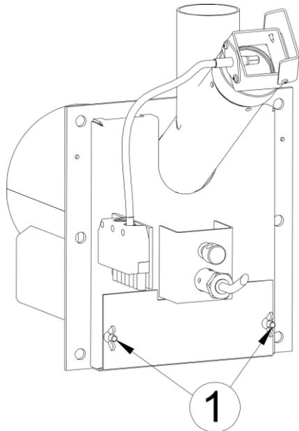
Controllare se il canale dell'aria primaria non sia ostruito da residui di combustione o cenere. Svitare le viti che regolano la portata d'aria (1), aprire bene il condotto e aspirare la cenere.
