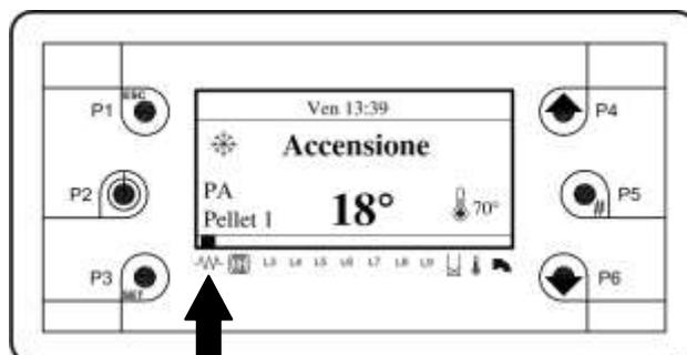
Questa è la fase di preriscaldamento della resistenza di accensione, sul display si illumina il led  $\sim$ . Ha durata di 2 minuti e il ventilatore passa alla minima velocità.
