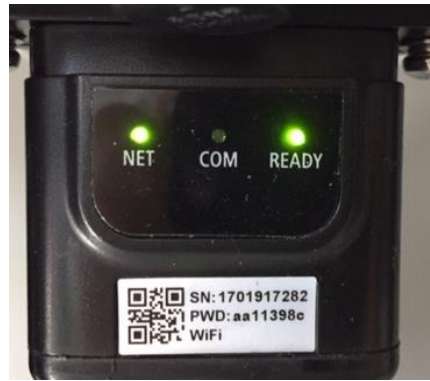
Figura 110 - Stato di comunicazione irregolare tra inverter e scheda
