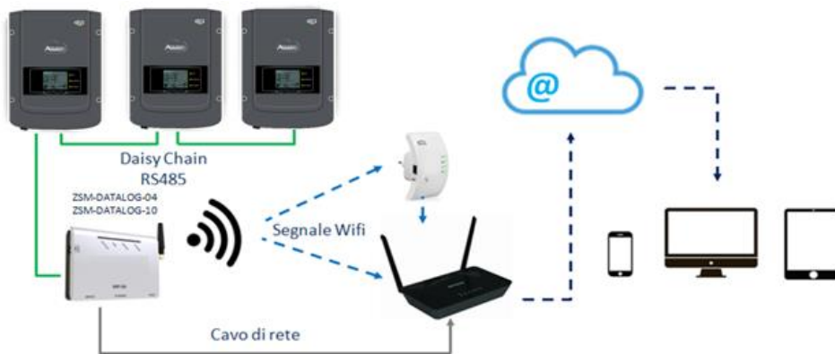
Figura 112 – Schema di connessione del datalogger ZSM-DATALOG-04 / ZSM-DATALOG-10
