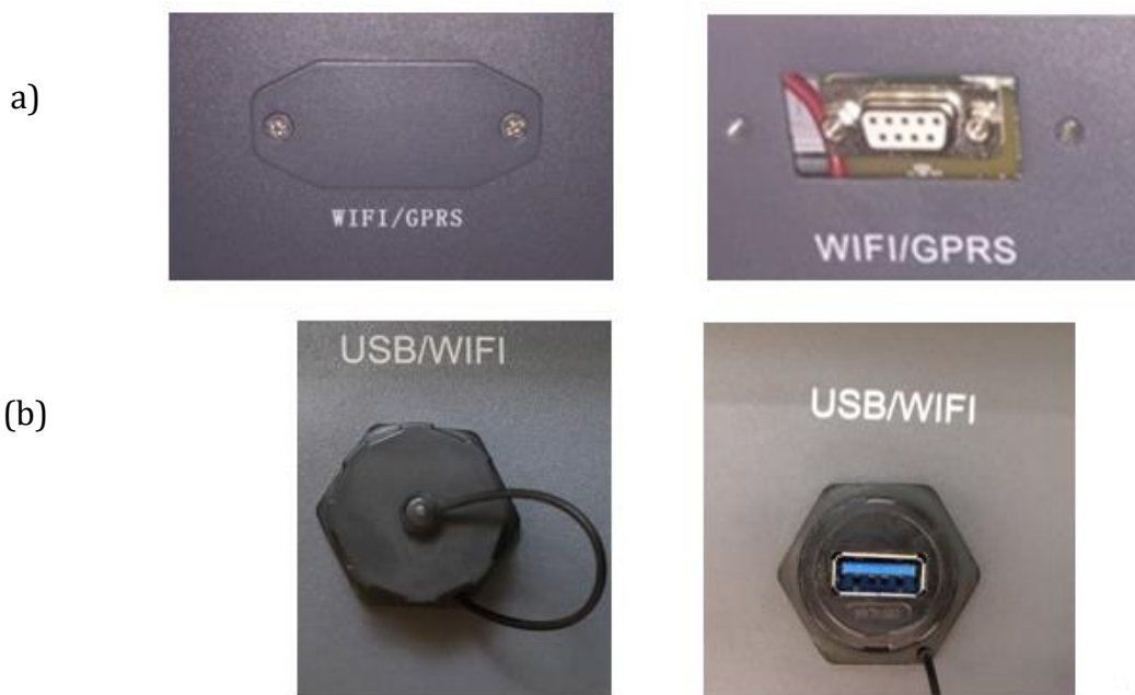
Figura 73 - Alloggiamento della scheda wifi esterna
