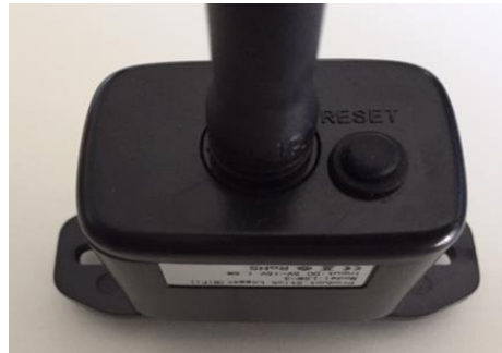
Figura 92 - Tasto di reset sulla scheda wifi
