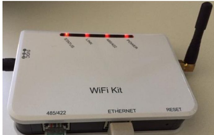
Figura 132- Led che indicano la corretta configurazione del datalogger
