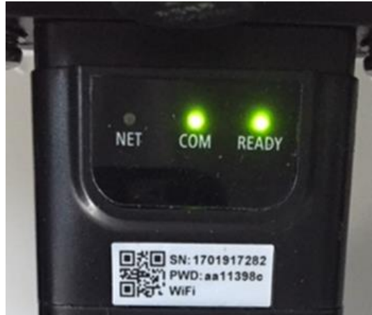
Figura 104 – Stato di comunicazione irregolare tra scheda e server remoto
