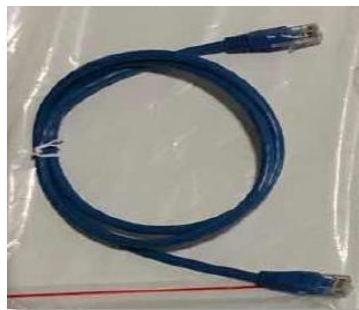
Figura 14 - Cavo di comunicazione fra batterie WeCo 4k4
