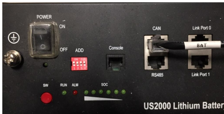
Figura 9 - Connessione cavo di comunicazione sulla batteria Pylontech
