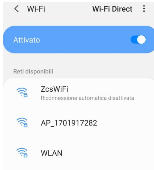
Figura 76 – Disattivazione della riconnessione automatica ad una rete
