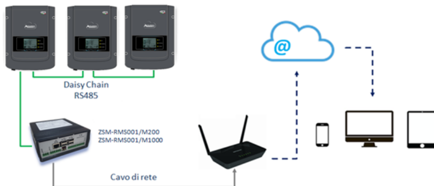
Figura 113 – Schema di funzionamento del datalogger ZSM-RMS001/M200 / ZSM-RMS001/M1000
