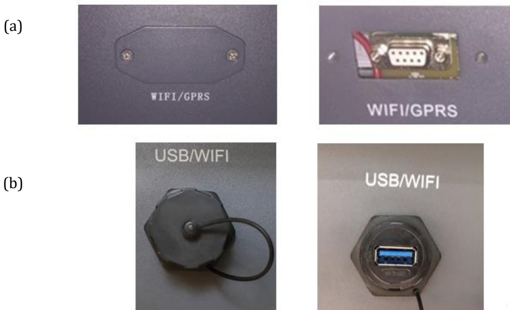
Figura 106 - Alloggiamento della scheda 4G
