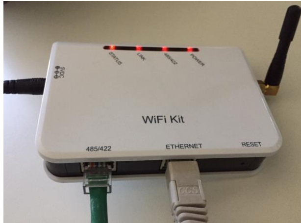
Figura 119 - Cavo ethernet connesso al datalogger
