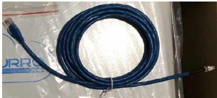
Figura 26 - Cavo di comunicazione fra inverter e batteria WeCo 5k3
