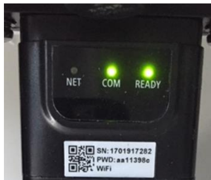
Figura 111 - Stato di comunicazione irregolare tra scheda e server remoto
