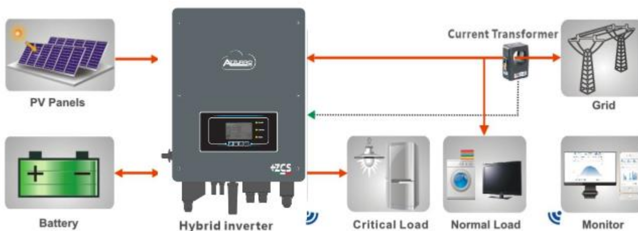
Figura 1 - Diagramma schematico di un impianto su cui è installato un inverter ibrido 1PH HYD3000-HYD6000-ZSS
