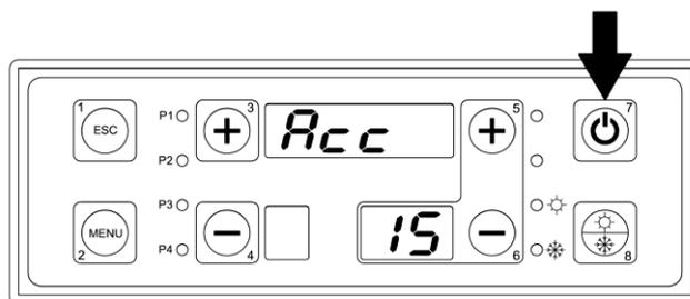
Nel momento in cui viene avviato il ciclo di funzionamento sul display superiore compare la scritta “ACC” indicante la fase di accensione caldaia. Questa scritta rimarrà sul display finché la temperatura dei fumi non supera la *minima temperatura fumi in accensione* (tarata a 70°) nel tempo impostato dal parametro *tempo fase di accensione* (tarato a 30 minuti) ; in questo stato il ventilatore funziona alla massima velocità.
