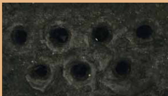
Scambiatore a tubi fumo tradizionale dopo pochi mesi di funzionamento (con incrostazioni di catrame)
