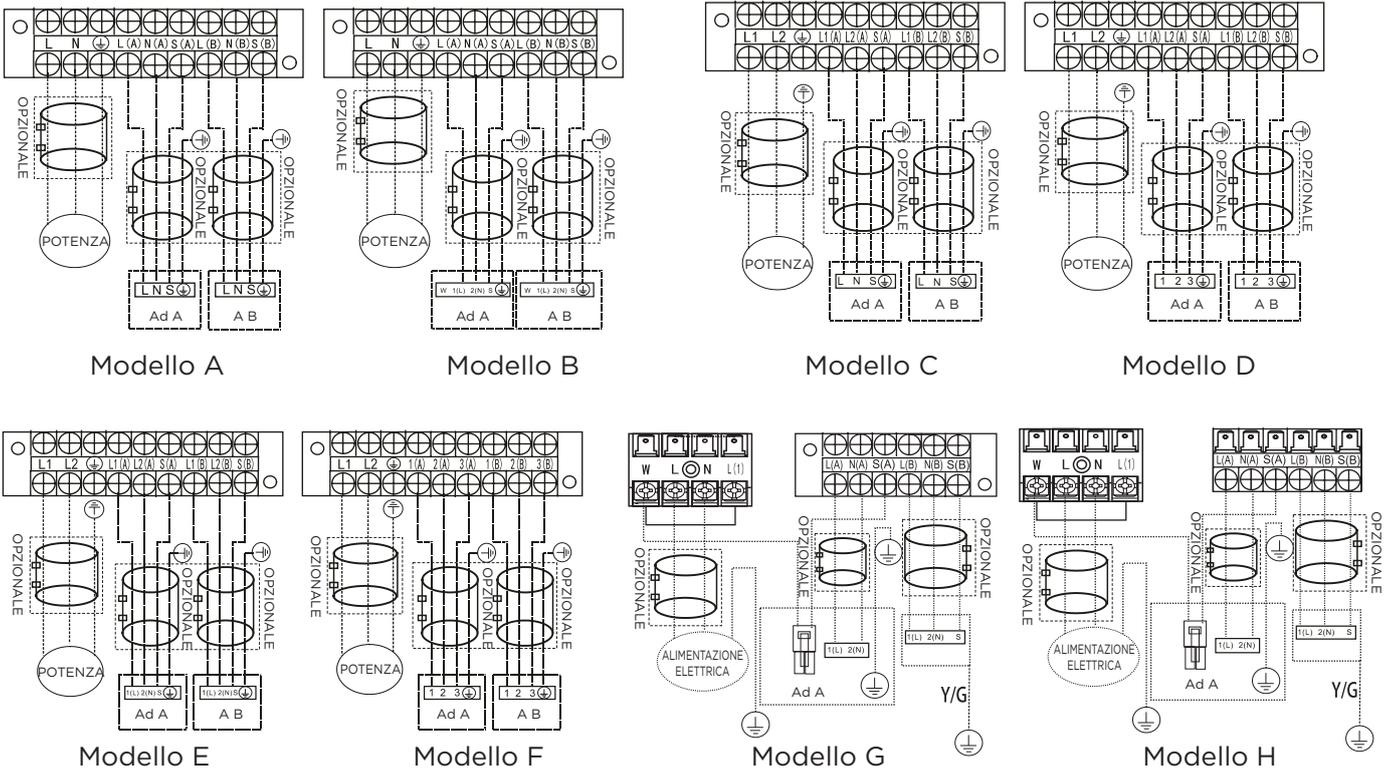
**NOTA:** Utilizzare l’anello magnetico (non incluso, parte opzionale) per fissare il cavo di collegamento tra unità interne ed esterne dopo l’installazione. Un anello magnetico viene utilizzato per un cavo.
