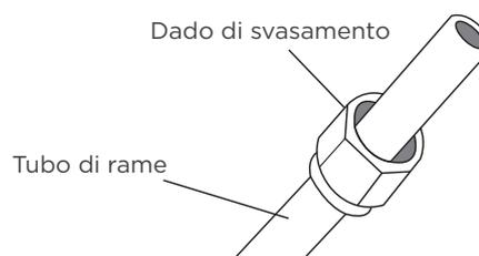
4. Rimuovere il nastro PVC dalle estremità del tubo quando è pronto per eseguire il lavoro di svasamento.
